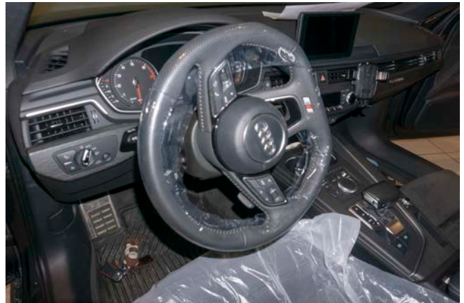
Рисунок 2 – Защита кузова и обода рулевого колеса
