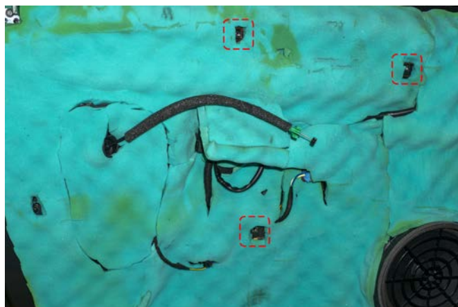
Рисунок 4 – Расположение винтов крепления
