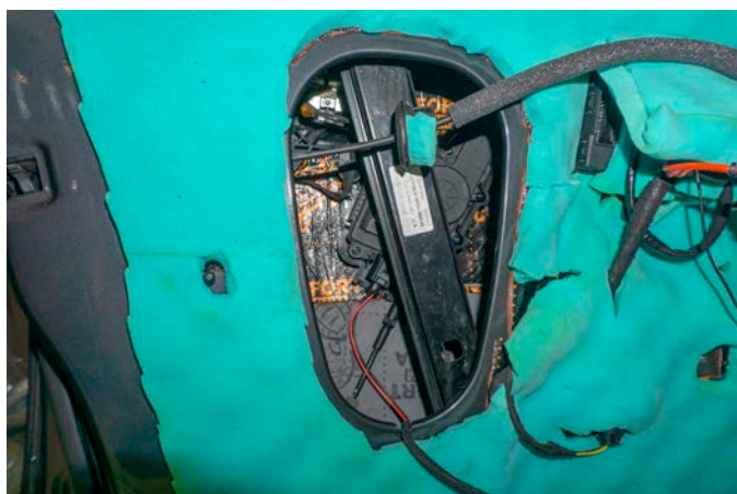
Рисунок 12 – Расположение электропривода доводчика
