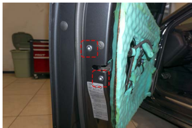
Рисунок 7 – Установка пластины доводчика
