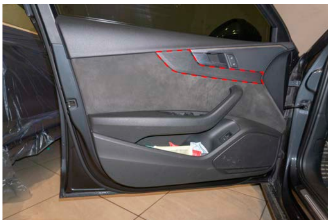
Рисунок 3 – Расположение декоративной накладки
