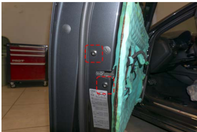
Рисунок 6 – Расположение винтов крепления замка
