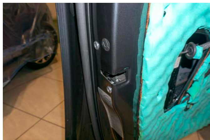
Рисунок 7 – Установка пластины доводчика
