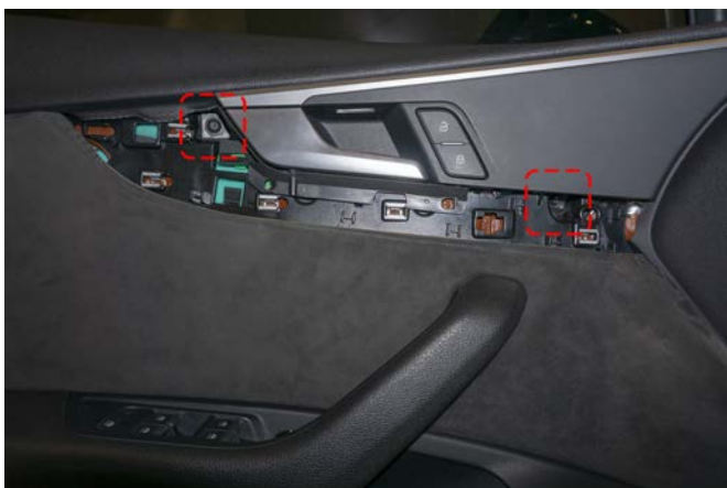
Рисунок 4 – Расположение винтов крепления
