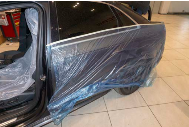
Рисунок 2 – Защита кузова и обода рулевого колеса
