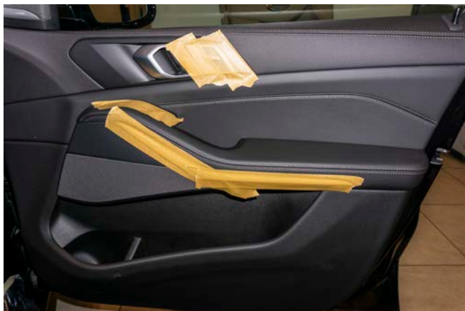
Рисунок 3 – Защита элементов двери автомобиля
