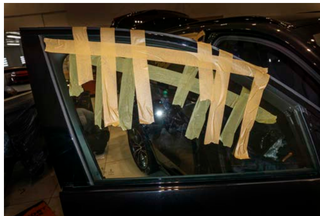
Рисунок 3 – Защита элементов двери автомобиля
