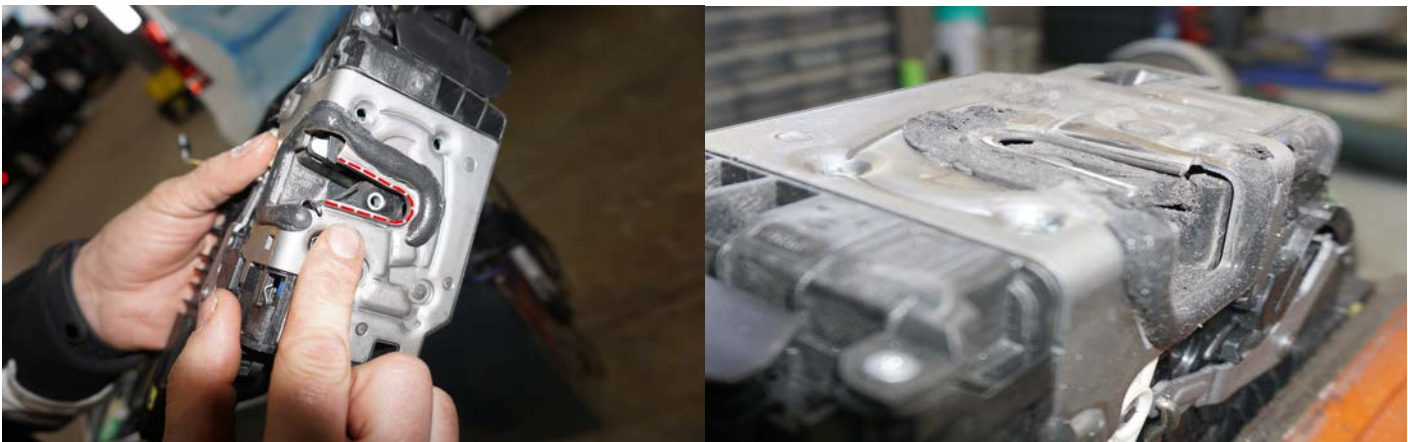
Рисунок 28 – Демонтаж направляющей механизма
