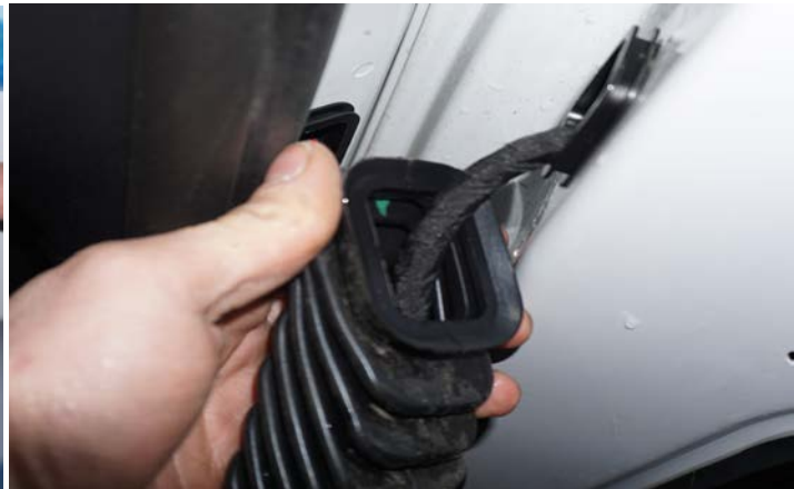
Рисунок 23 – Демонтаж штатного замка и резиновой гофры
