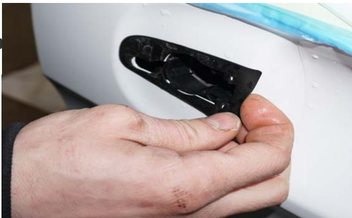
Рисунок 21 – Демонтаж ручки двери
