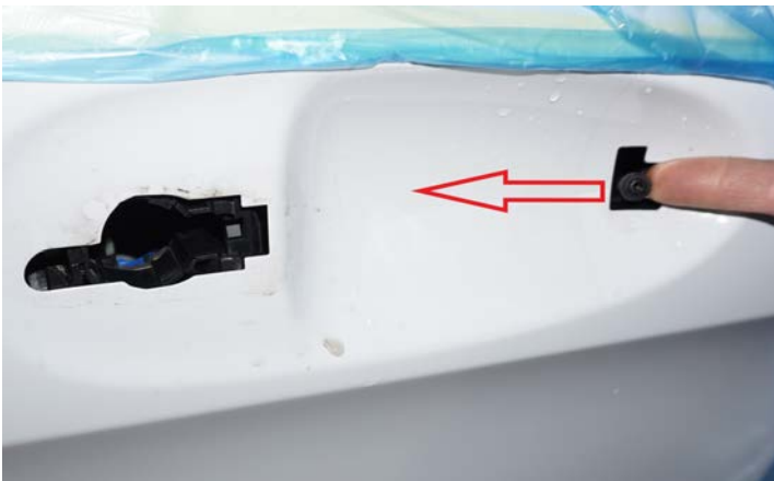
Рисунок 23 – Демонтаж штатного замка и резиновой гофры
