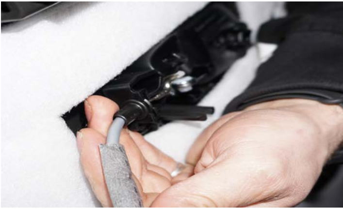
Рисунок 11 – Расположение троса от ручки двери
