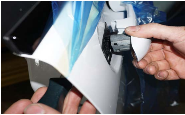
Рисунок 19 – Демонтаж ручки двери
