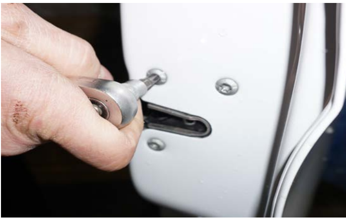
Рисунок 22 – Демонтаж штатного замка
