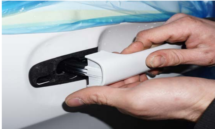
Рисунок 20 – Демонтаж ручки двери
