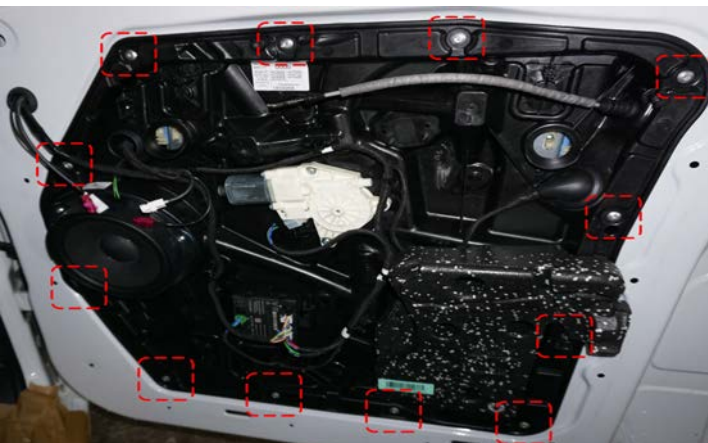
Рисунок 24 – Демонтаж заклепок карты двери
