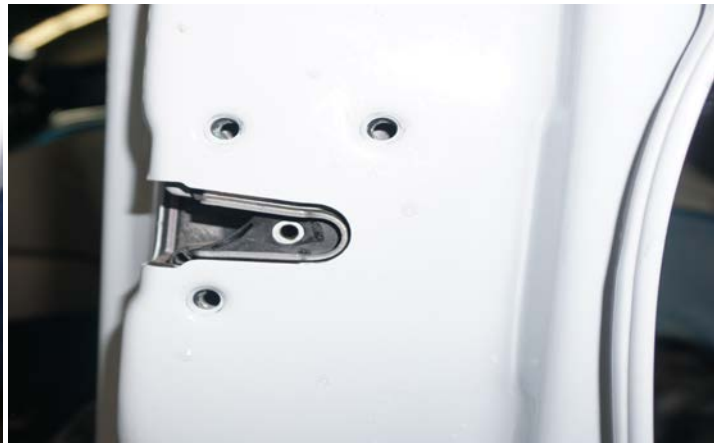
Рисунок 22 – Демонтаж штатного замка
