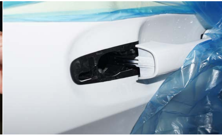
Рисунок 19 – Демонтаж ручки двери
