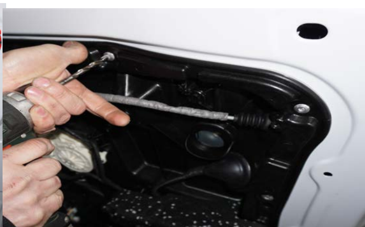
Рисунок 24 – Демонтаж заклепок карты двери
