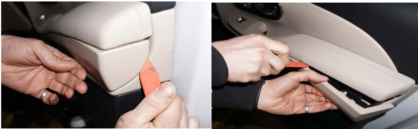
Рисунок 5 – Демонтаж декоративной накладки
