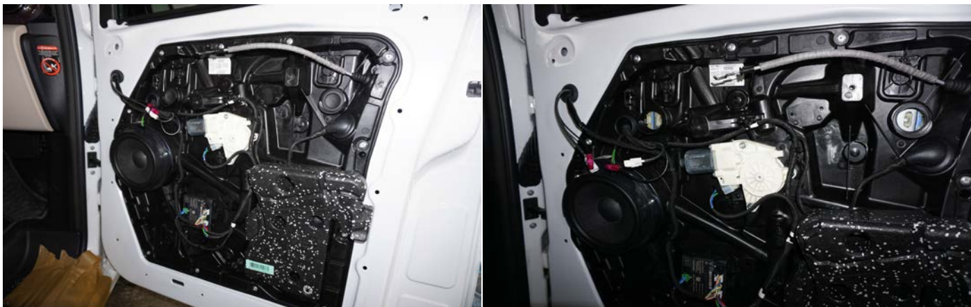
Рисунок 14 – Демонтаж резиновых заглушек
