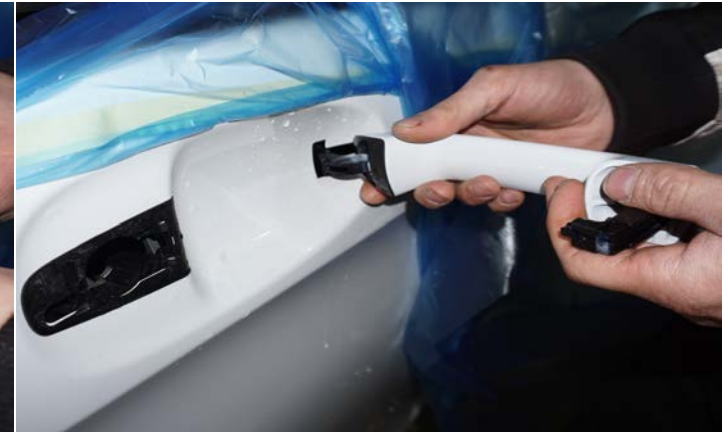
Рисунок 20 – Демонтаж ручки двери
